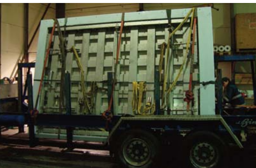
Verladen des zusammengebauten Drucktors im Werk.
