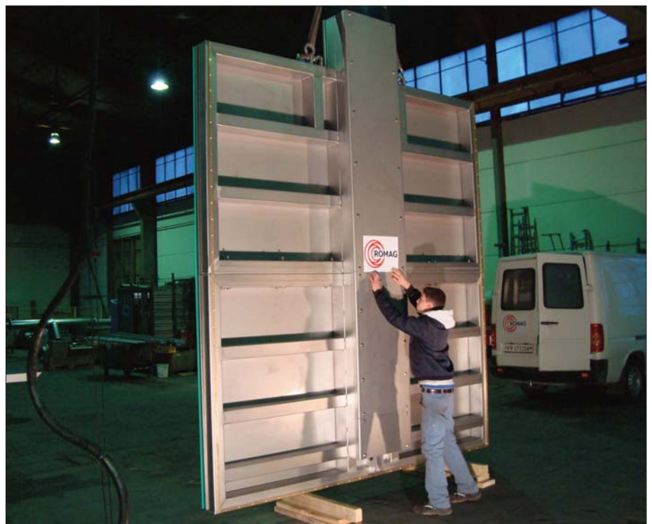
Eine der 4 «kleineren» Dammbalken im Werk ROMAG.
