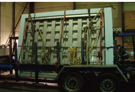
Chargement en usine de la porte étanche assemblée.
