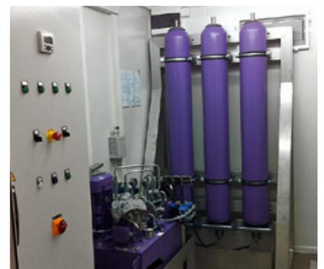
Unité hydraulique avec accumulateurs et poste de commande dans le container
