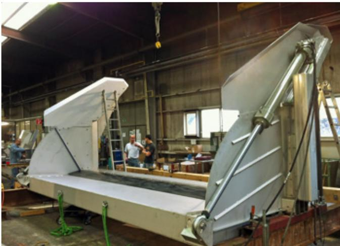
Lame de régulation en fabrication
