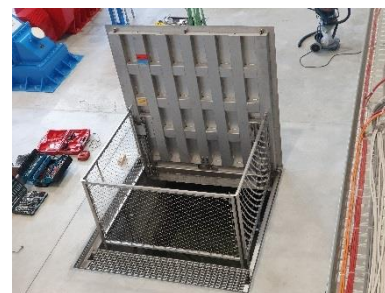
Schattdorf : construction spéciale, couvercle de regard du type S14, 2000 x 2000 mm, balustrade manuelle avec WebNet, caillebotis partiel
