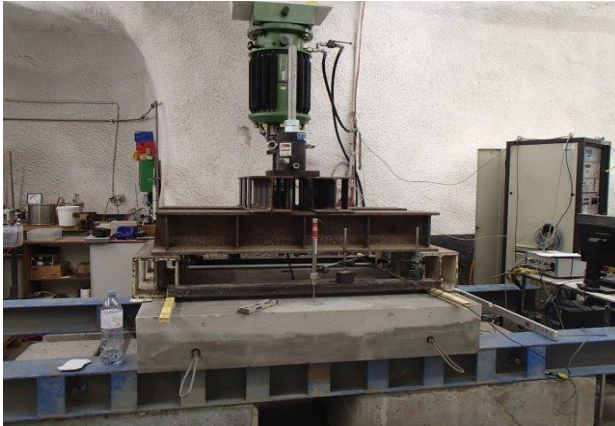
Versuchsaufbau Prüfung der Sicherung im Rahmen
