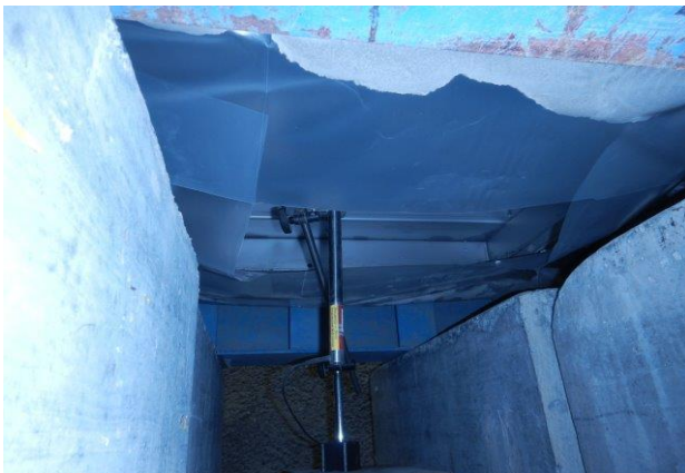
Versuchsaufbau Prüfung der Tragfähigkeit (Messfühler)
