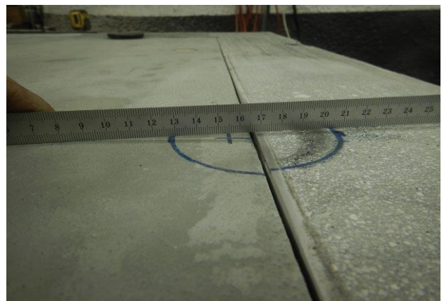
Versuch 2 nach Prüfung (entstandener Versatz)
