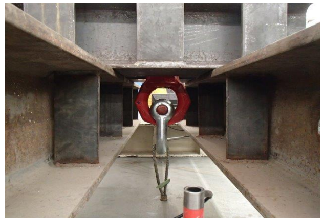
Versuchsaufbau Prüfung der Sicherung im Rahmen
