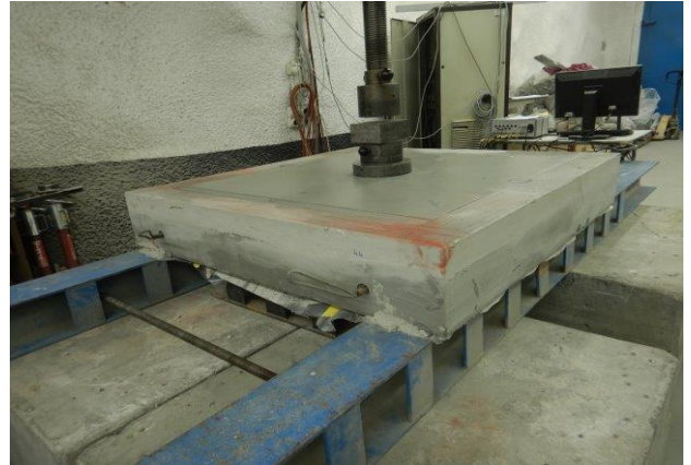
Versuchsaufbau Prüfung der Tragfähigkeit
