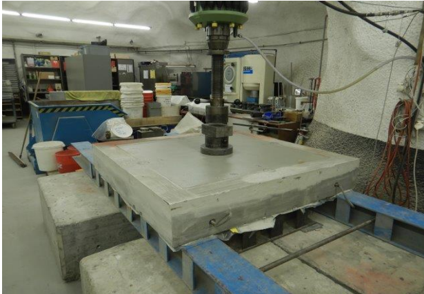
Versuchsaufbau Prüfung der Tragfähigkeit
