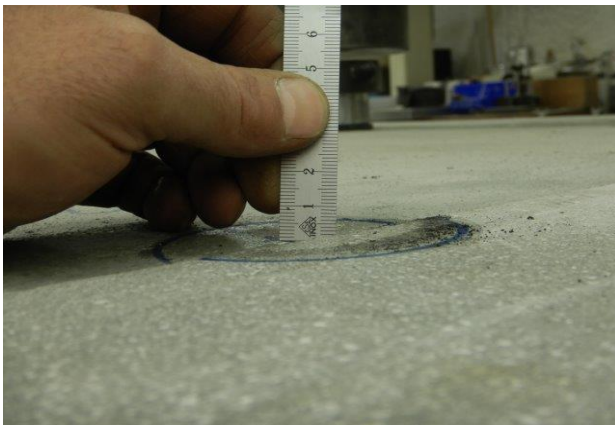
Versuch 3 nach Prüfung (entstandener Versatz)
