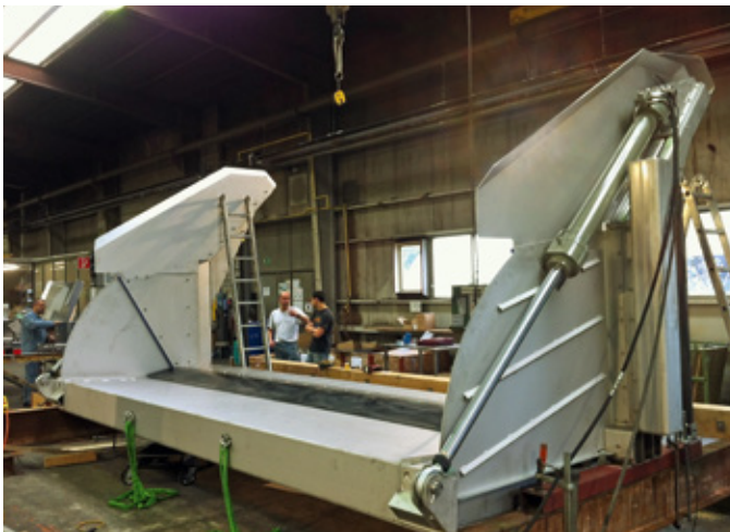
Regelklappe in Fabrikation
